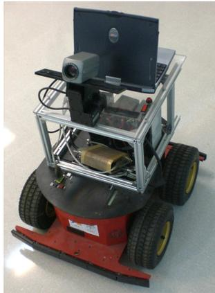
Figura 2.1: Robot móvil utilizado para la toma de imágenes.
